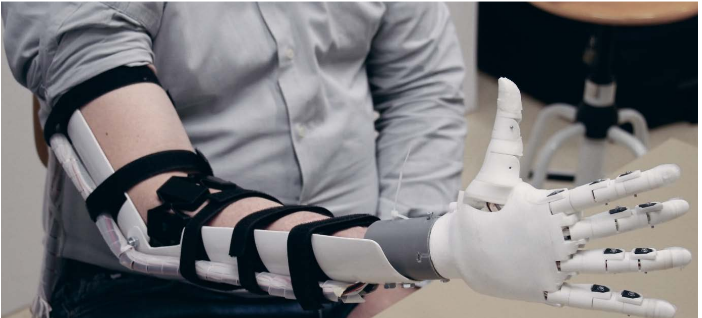
Photo Projet d'une prothèse de main imprimée en 3D © Cimark
